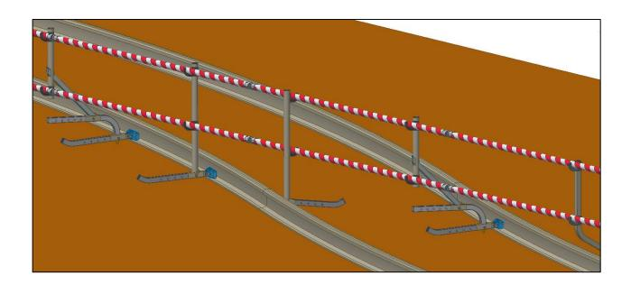
Der Abstand der Geländer-Pfosten des RSS-Systems beträgt standardmäßig mit Kunststoff-Querholm maximal 3 m. Der Abstand von der Gleismittellinie des durchgehende Gleis kann zwischen 1,95 und 2,55 m eingestellt werden.
