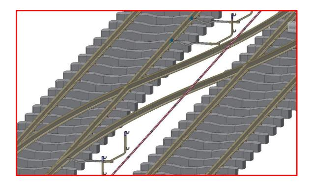
Nun werden die Geländer-Pfosten mit Abständen von weniger als 3 Meter auseinander am Gleis montiert. Es hängt von der Weichengröße ab, wie viele Gelände-Pfosten erforderlich sind.
